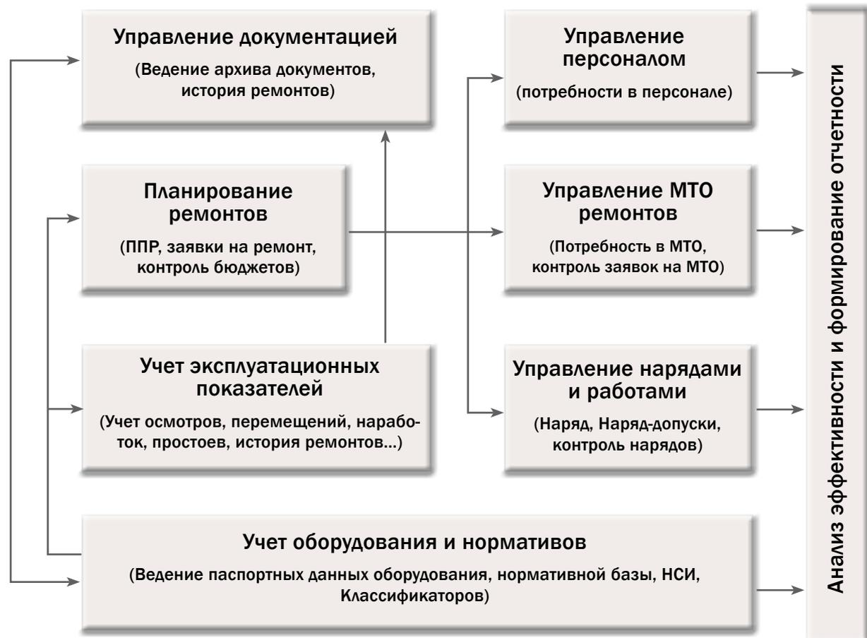
Схема 1. Типовая процессная модель проведения ремонтов
