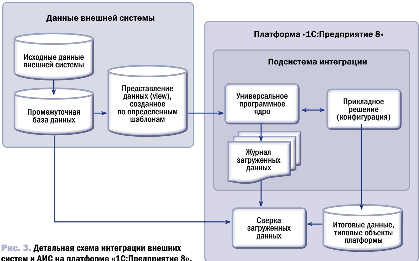
**Рис. 3.** Детальная схема интеграции внешних систем и АИС на платформе «1С:Предприятие 8».
