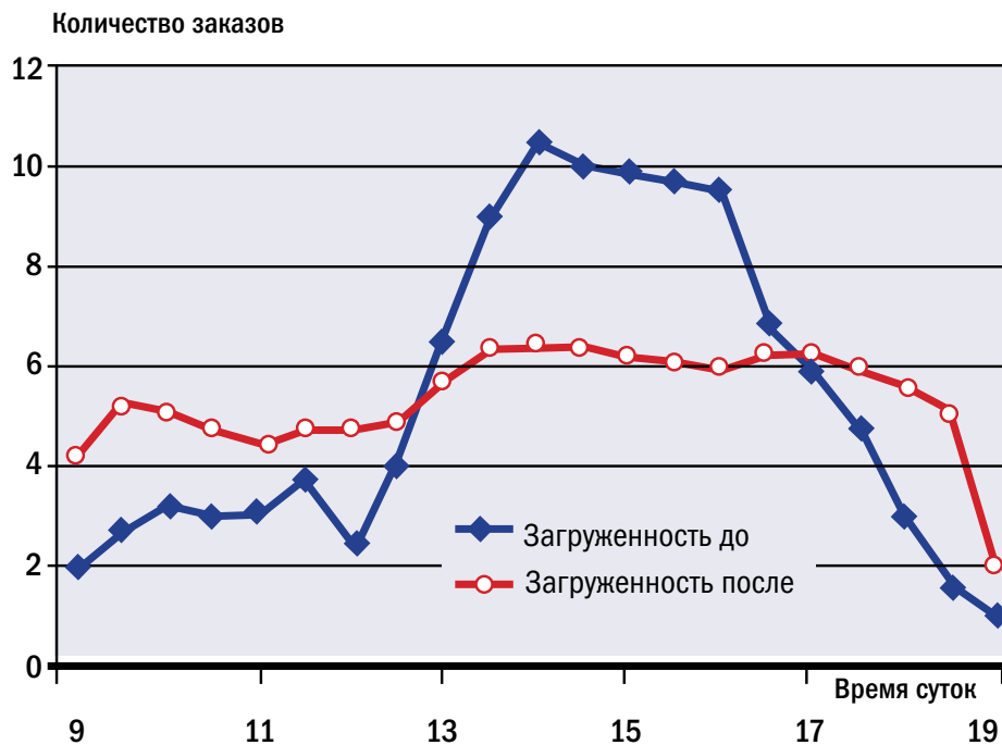
Рис. 2. Загруженность склада до автоматизации и после.
